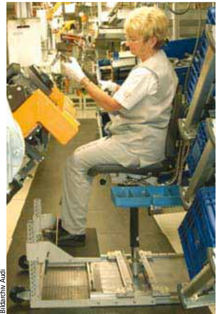
Abb. 1: Die Cockpit-Vormontage des Audi A3 kann sitzend durchgeführt werden. Es ist möglich, diesen Arbeitsplatz auch mit Mitarbeitern zu besetzen, die nicht den ganzen Tag stehen dürfen.
