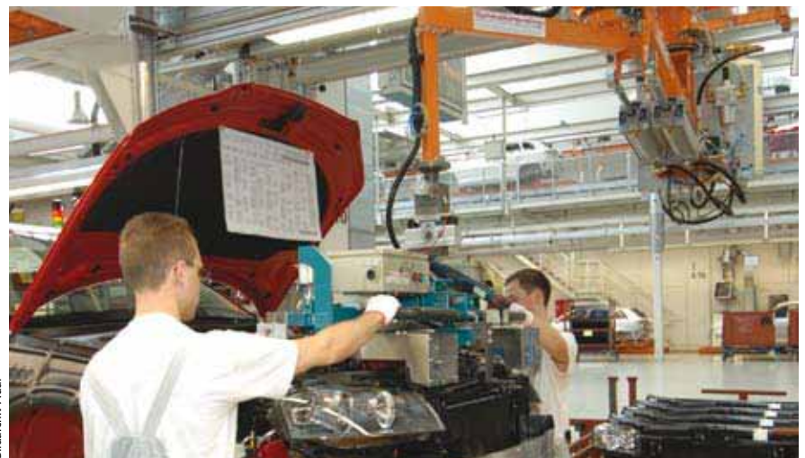
Abb. 2: Die Bewegung des Frontendmoduls wird mit einer Hebehilfe durchgeführt.
