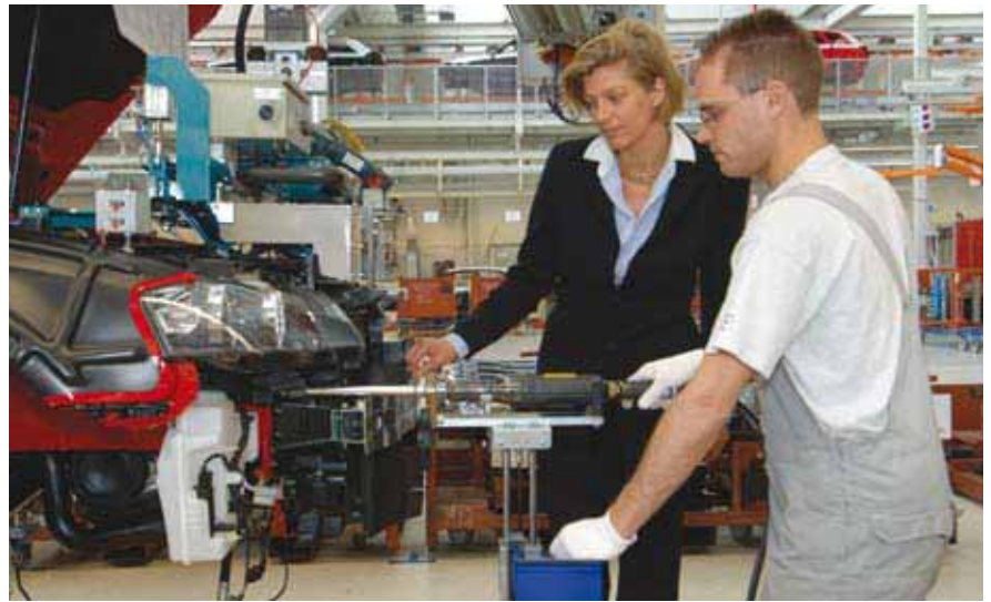
Abb. 3: Mithilfe eines höhenverstellbaren Tisches kann der Mitarbeiter das Frontendmodul befestigen. Die Betriebsärztin erarbeitet mit dem Mitarbeiter vor Ort die richtigen Bewegungsabläufe.
